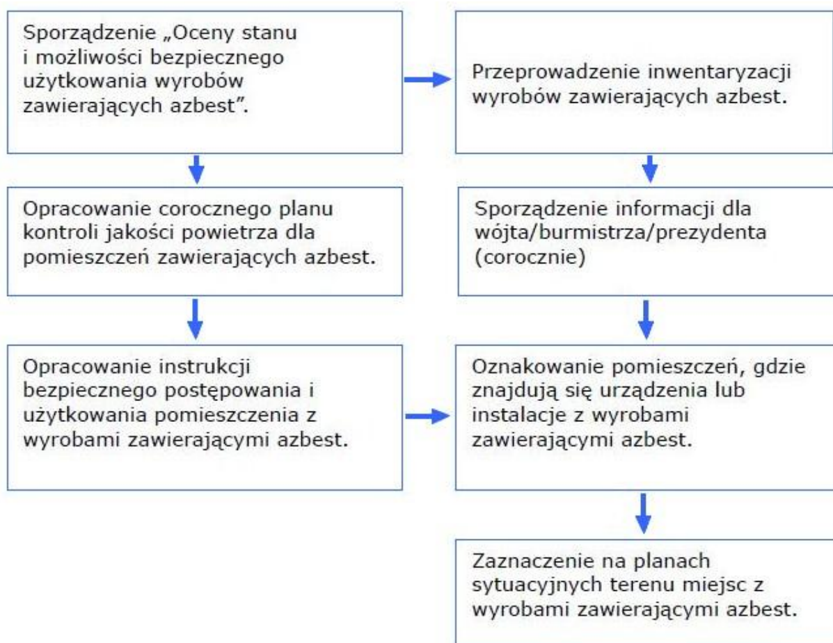
Rysunek 4. Schemat procedury postępowania właścicieli i zarządców przy użytkowaniu obiektów i terenów z wyrobami zawierającymi azbest.
